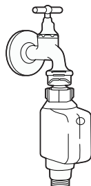
tuyau d'alimentation de sécurité
